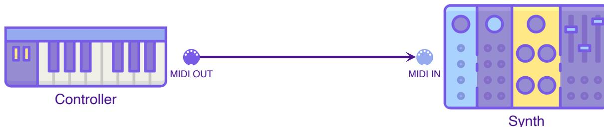
Figura 1.8. Una catena MIDI minima: collegamento di un *controller* a un *synth*.
